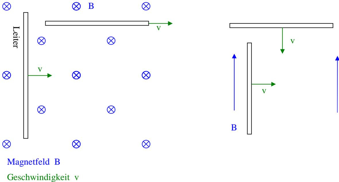
Eine Leiterschleife mit Spannungsmessgerät wird mit konstanter Geschwindigkeit  $v$  durch das Magnetfeld  $B$  bewegt. Das Magnetfeld sei außerhalb des eingezeichneten Bereichs  $0$ . Welche induzierten Spannungen treten an den einzelnen Abschnitten der Leiterschleife auf? Zeigen die Voltmeter in Stellung (1) bzw. (2) Spannung an?
