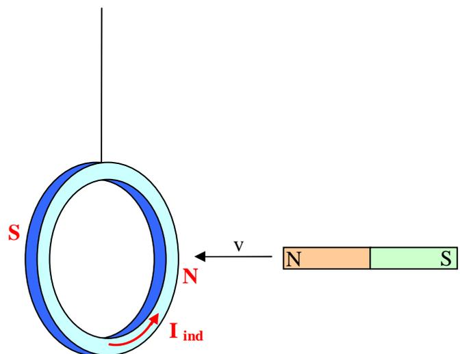
Der Kupferring wird nach links ausweichen (und dann hin und her schwingen, wobei diese Schwingung durch Wirbelstromverluste schnell zur Ruhe kommt).
