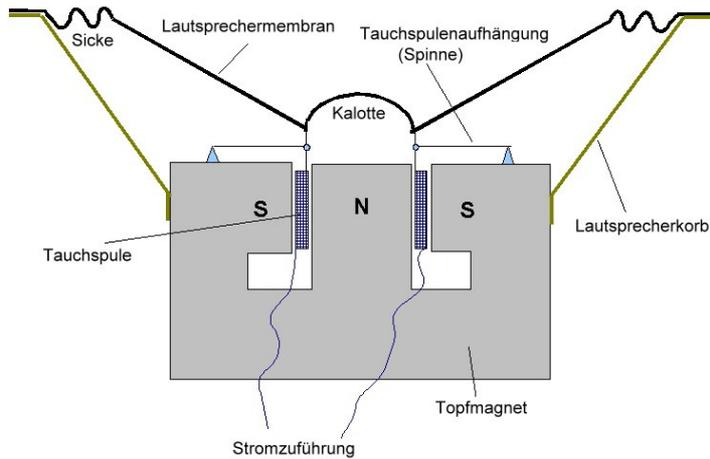
Querschnitt durch einen dynamischen Lautsprecher
