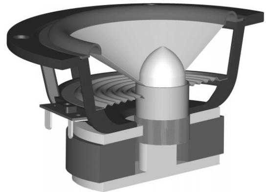
Ein dynamischer (auch elektrodynamischer) Lautsprecher wandelt elektrische Energie in Schall um. Stromstärkeschwankungen in der Tauchspule bringen die damit fest verbundene Membran zum entsprechenden Mitschwingen und die schwingende Membran erzeugt den hörbaren Schall.
