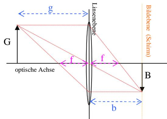
Es soll nun untersucht werden, bis zu welchem minimalen Abstand  $g + b$  zwischen Gegenstand und Schirm noch ein scharfes Bild durch eine Sammellinse der Brennweite  $f$  erzeugt werden kann.
