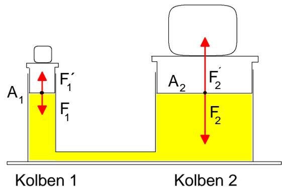
Wie weit muss man den Kolben 1 nach unten drücken, wenn der Kolben 2 um 1,0cm gehoben werden soll?
