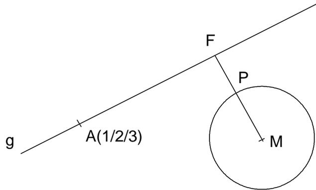
$$\vec{AF} = \frac{\begin{pmatrix} 3 \\ 5 \\ 4 \end{pmatrix} \circ \begin{pmatrix} 12 \\ 4 \\ 11 \end{pmatrix}}{(\sqrt{3^2+5^2+4^2})^2} \cdot \begin{pmatrix} 3 \\ 5 \\ 4 \end{pmatrix} = \begin{pmatrix} 6 \\ 10 \\ 8 \end{pmatrix} \Rightarrow F(7/12/11)$$
