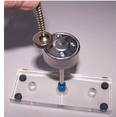
Das nebenstehende Bild (Quelle: LeiFi) zeigt den Aufbau eines Wirbelstrom-Tachometers.
